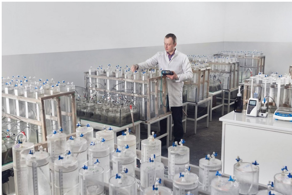
RYS. 17. Reaktory do badań wydajności biogazowej/metanowej wg normy DIN 38 414/S8
