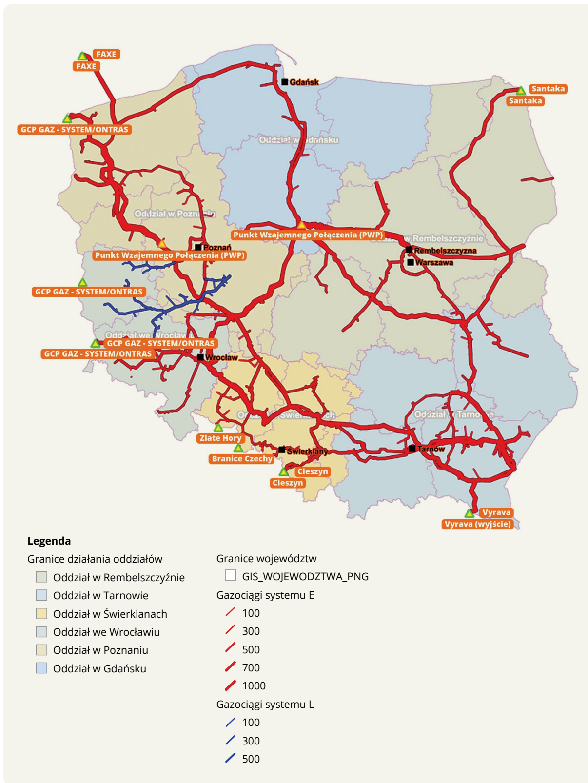
RYS. 18. Sieć przesyłowa dal gazu ziemnego wysokometanowego grupy E (kolor czerwony) i gazu ziemnego zaazotowanego Lw (kolor niebieski)
