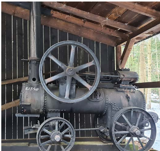
Foto. 8. Lokomobila do napędu urządzeń wiertniczych lub innych urządzeń mechanicznych [foto C. Rybicki]
