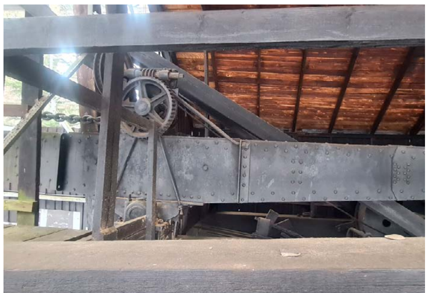
Foto. 2. Wahacz wraz mechanizmem popuszczadła ślimakowego [foto C. Rybicki]
